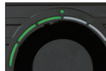
i driftstypen "Purifier" (Luftrensing) lyser LED-ene grønt
