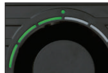
I läget "Purifier" (Luftrening) lyser LED-lamporna grönt
