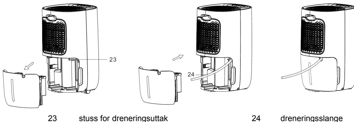
For å få vannet til å renne ned slangen i stedet for tanken ta først ut tanken. Skiv en slange med 14mm innvendig diameter inn på tuten. Sett tanken tilbake på plass og pass på at slangen går nedover uten knekk eller blokering og kutt av overflødig lengde. Denne avfukteren leveres uten slange for å redusere mengden plast i søppelfyllingene. Slanger kan kjøpes lokalt eller direkte fra Meaco
